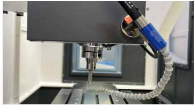
急速气冷系统应用于台式搅拌摩擦焊接设备
