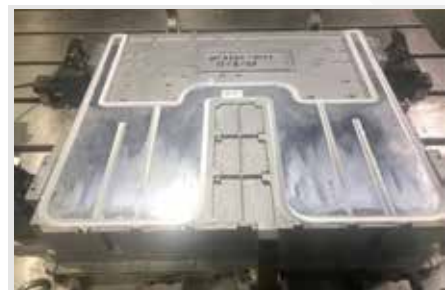
典型恒压力控制系统下产品焊接外观
