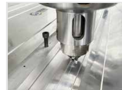
静轴肩搅拌摩擦焊接过程
