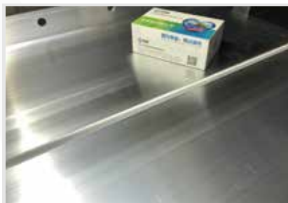
恒压力控制功能下焊缝外观
