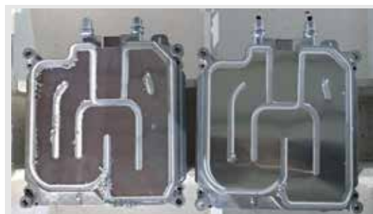
是否采用恒压力控制的产品焊接外观图（左侧未采用）
