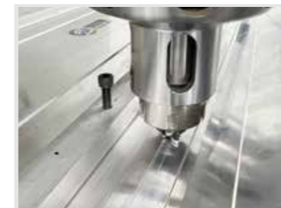
静轴肩搅拌摩擦焊接过程
